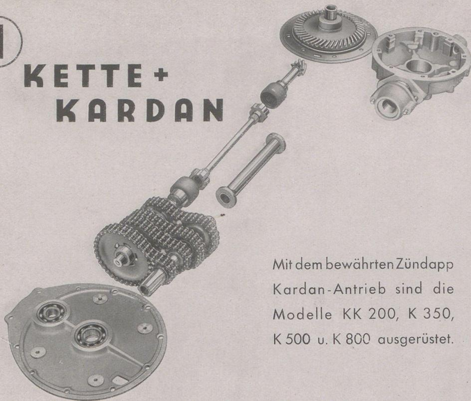
Mit dem bewährten Zündapp Kardan-Antrieb sind die Modelle KK 200, K 350, K 500 u. K 800 ausgerüstet.
